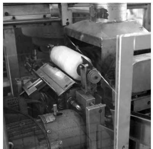
Les rouleaux sont brossés avant de passer au contrôle final
